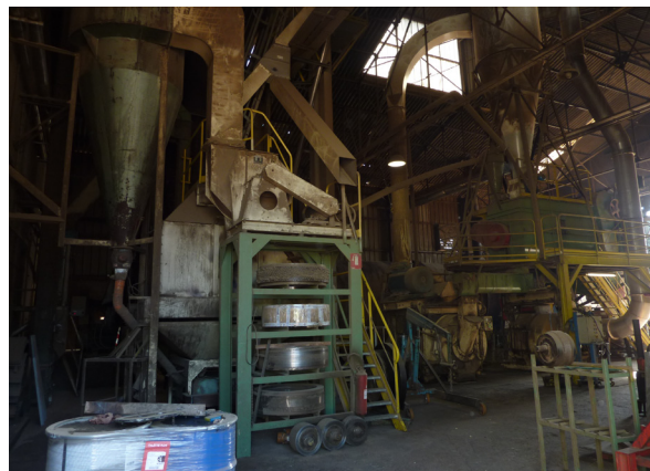
Vue sur la presse, dernière étape de production des granulés
